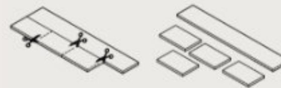
Lättbetong kapas till mindre bitar
